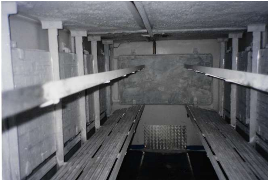
Figura 17.6 Placas eutéticas no interior de um veículo de entrega local - suportes de prateleiras para cestas de carga também visíveis (Cambridge Refrigeration Technology).
