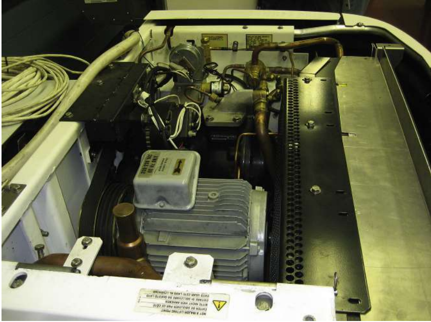
Figura 17.5 Caminhão diesel auto-alimentado com opção de espera elétrica (Thermo King).
