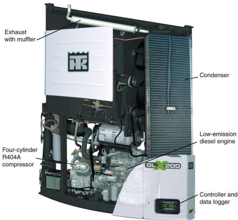
Figura 17.4 Unidade de refrigeração de transporte independente com acionamento por motor diesel (Thermo King).
